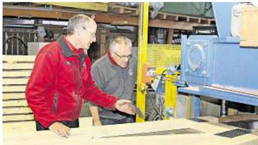
Edi Zumbühl (rechts) und Hans Dettling: Soeben werden Nagelplattenbinder hydraulisch in das Holz gepresst. Bild Sandrine Hedinger
